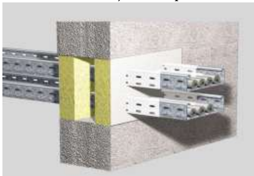
Zaptivanje prolaza kablova i regala sa pjenastom izolacijom-čepovima kroz konstrukcije između požarnih sektora
